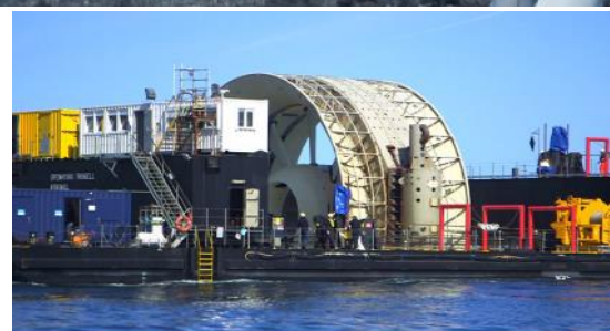
Hydrolienne Open Hydro sur la barge d'installation
